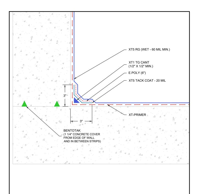
WALL CRACK AND JOINT TREATMENT - PLAN VIEW - HIGH TRAFFIC\_WATERFLOW - CONSTRUCTION JOINT - CORNER
